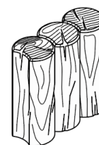
Obr. č. 3 – Palisádový obrubník - kuláč Ø 12 / 30
